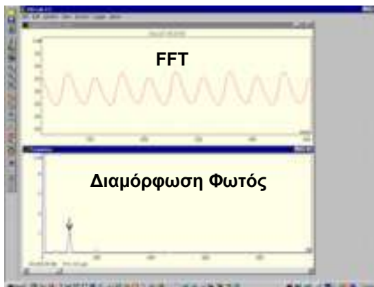
Μέτρηση της διαμόρφωσης των 50Hz μιας λάμπας φθορισμού.
